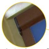
Store à enroulement avec coffre en aluminium (section arrondie de 42mm de profondeur sur 55mm de hauteur) et coulisses (section de 40mm de Large x 22mm de Profondeur), coloris blanc laqué ou marron laqué (Autres coloris en option).
